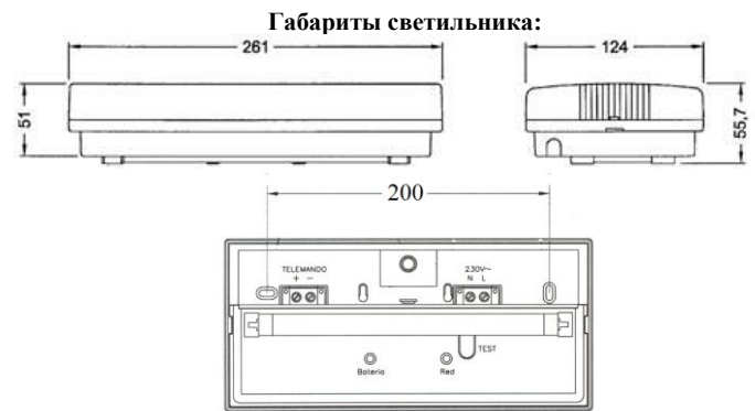
Рис. I - Схема подключения светильников непостоянного/постоянного действия.
