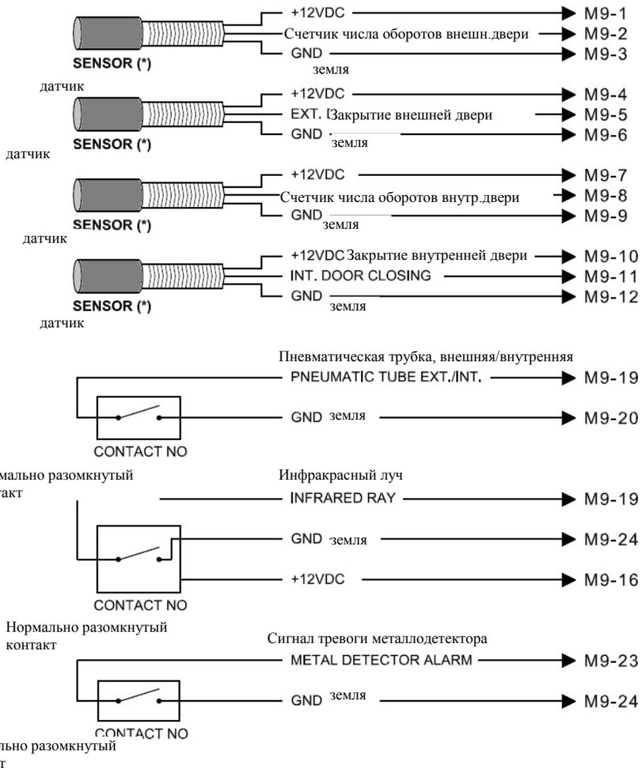
(\*) Индуктивный бесконтактный датчик типа NPN NO 2 кГц 12В пост.тока
