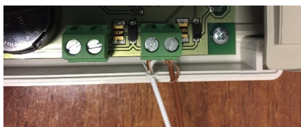
Рис. 2. Подключение кабеля к «РС-К» и преобразователю интерфейсов
