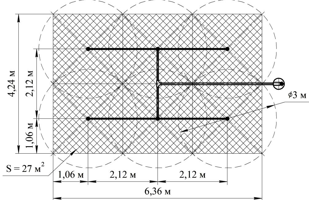
Рисунок 12 - Вариант трубной разводки по вписанным квадратам на 6 насадков-распылителей
