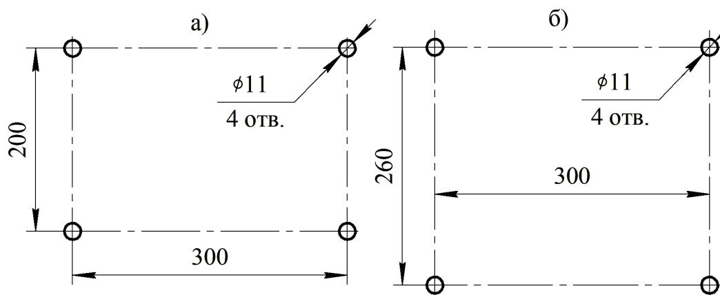
Координаты отверстий: а - для крепления к полу;
