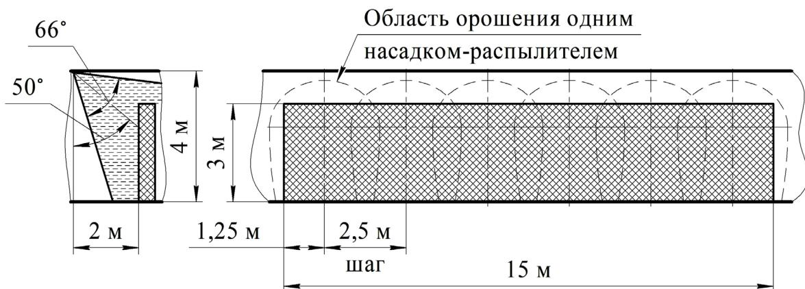
Рисунок 16 - Противопожарная защита боковой поверхности стеллажа 6-ю насадками-распылителями
