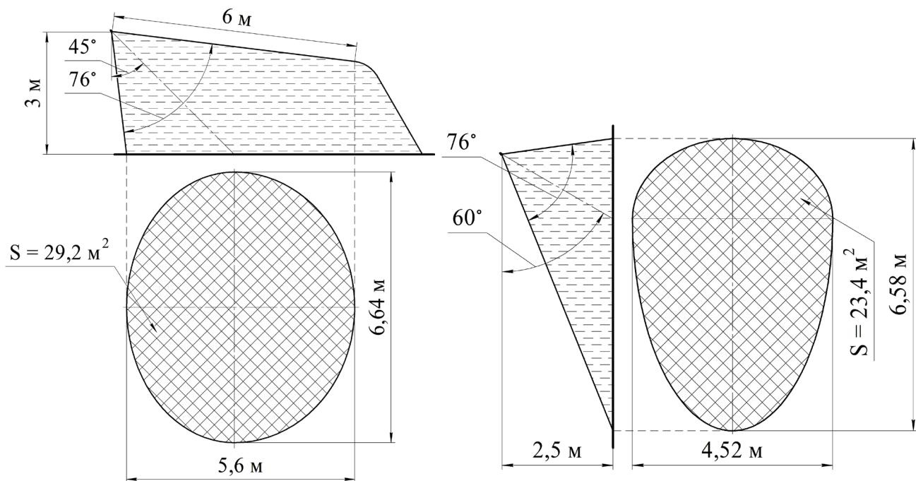
Рисунок 18 - Область орошения на горизонтальной плоскости
