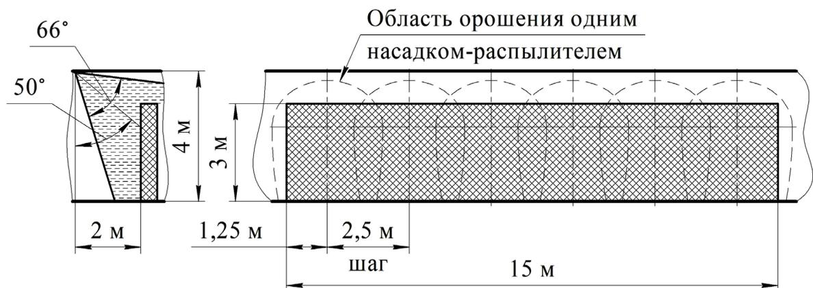
Рисунок 16 - Противопожарная защита боковой поверхности стеллажа 6-ю насадками-распылителями
