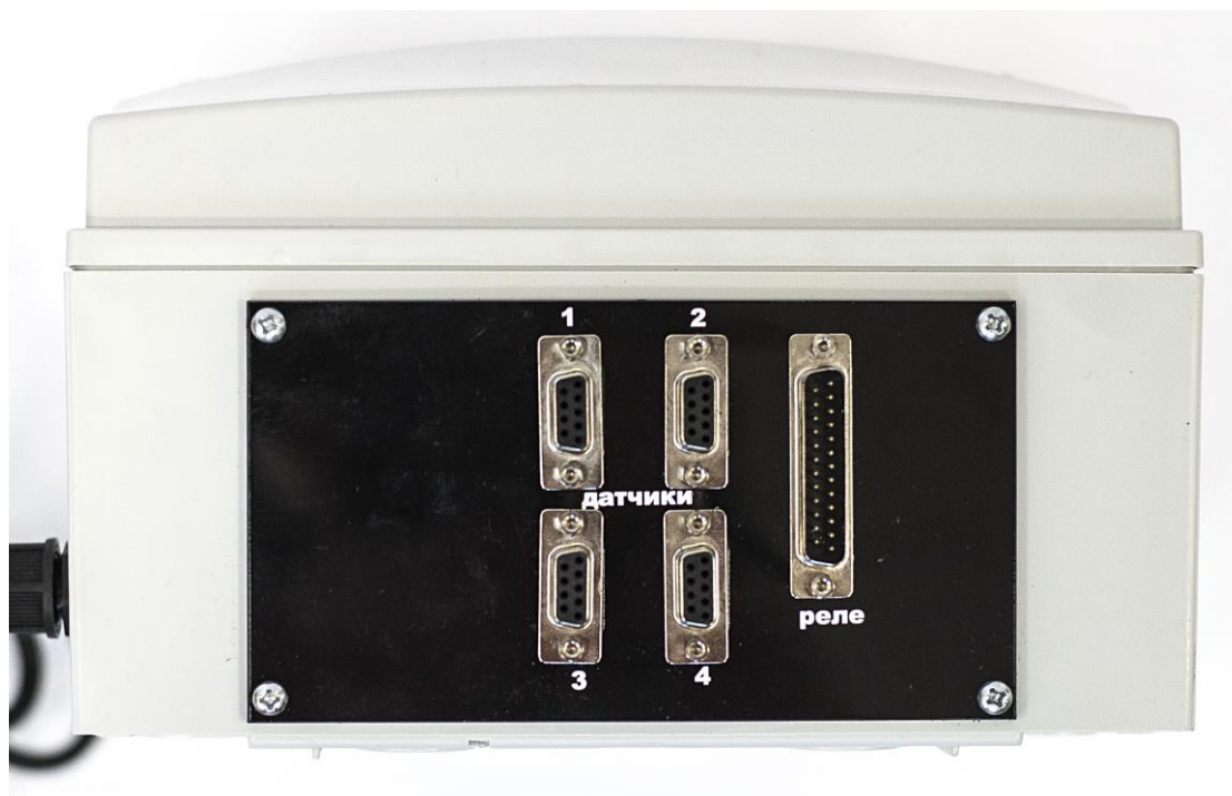
Рис.2.1 Вид задней панели блока информационного СИГМА-03.ИПК 4.4 /4.8
