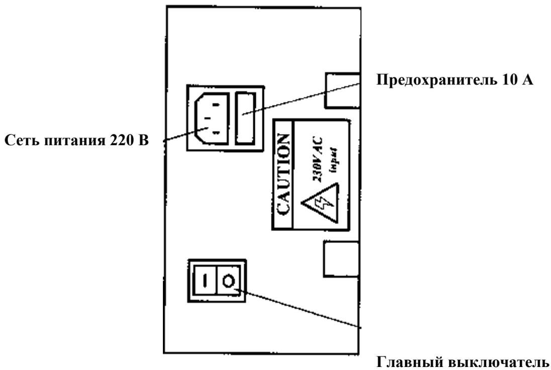
Вид сбоку на заднюю панель
