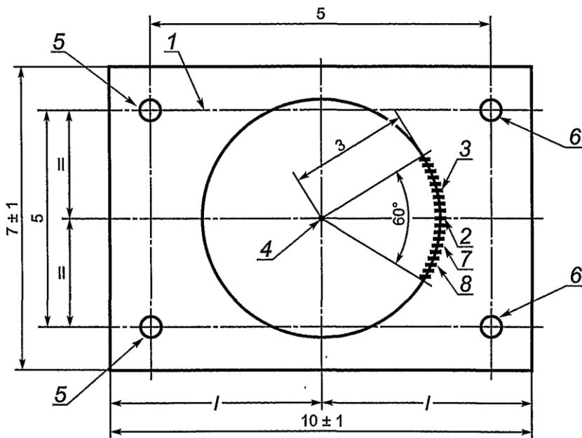
1 — помещение для проведения огневых испытаний; 2 — измеритель оптической плотности дыма (приемник/передатчик);
