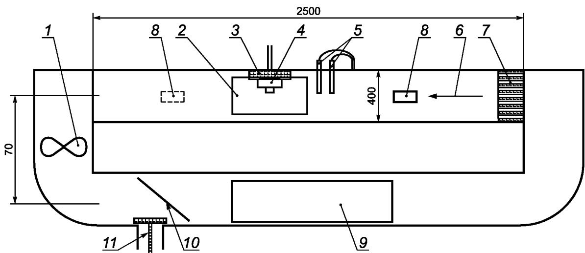
1 — вентилятор с двигателем; 2 — крышка отсека для установки испытываемого ИП со стеклянным смотровым окном; 3 — площадка с поворотным устройством для установки испытываемого ИП; 4 — испытываемый ИП; 5 — измерители температуры и скорости потока воздуха; 6 — направление потока воздуха; 7 — линеаризатор; 8 — устройство для измерения удельной оптической плотности; 9 — отсек нагревателя; 10 — регулятор скорости потока воздуха; 11 — вентиляционное отверстие.
