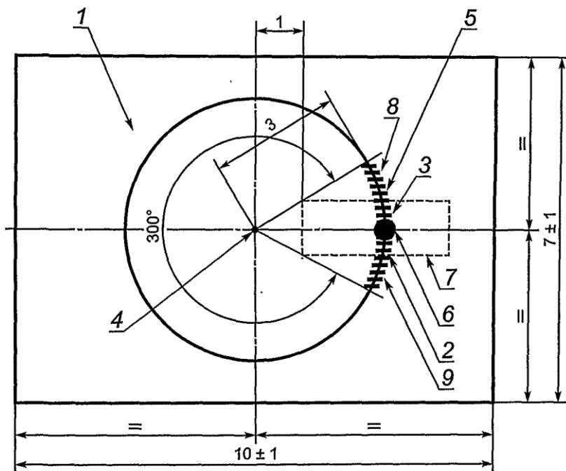
1 — помещение для проведения огневых испытаний; 2 — измеритель оптической плотности дыма (приемник/передатчик);
