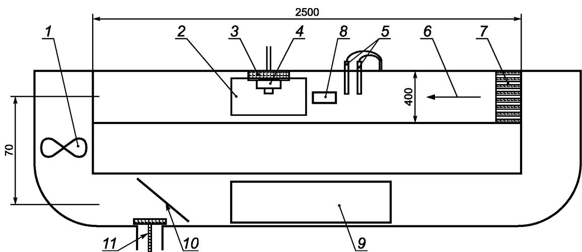
1 — вентилятор с двигателем; 2 — крышка отсека для установки испытываемого ИПДИ со стеклянным смотровым окном; 3 — площадка с поворотным устройством для установки испытываемого ИПДИ; 4 — испытываемый ИПДИ; 5 — измерители температуры и скорости потока воздуха; 6 — направление потока воздуха; 7 — линеаризатор; 8 — контрольная ионизацияционная камера; 9 — отсек нагревателя; 10 — регулятор скорости потока воздуха; 11 — вентиляционное отверстие
