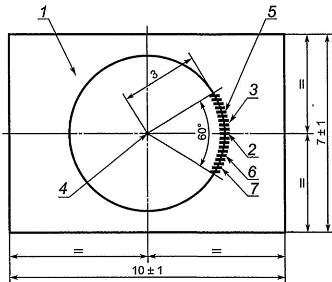
1 — помещение для проведения огневых испытаний; 2 — измеритель оптической плотности дыма (приемник/передатчик);
