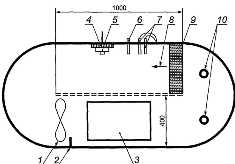
1 — вентилятор с двигателем; 2 — входной патрубок газа; 3 — техническое окно; 4 — площадка с поворотным устройством для установки испытываемого ИПГ; 5 — испытываемый ИПГ; 6 — газоанализатор; 7 — измерители температуры и скорости потока воздуха; 8 — направление потока воздуха; 9 — линеаризатор; 10 — приточно-вытяжная вентиляция
